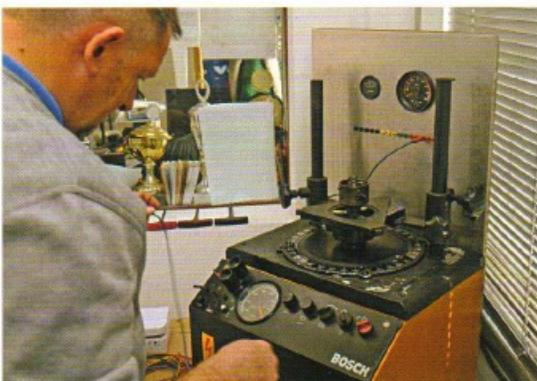
**Oldie:** Mit dem Bosch-Zündverteiler-Prüfstand lassen sich alle kontaktgesteuerten Zündanlagen optimieren
