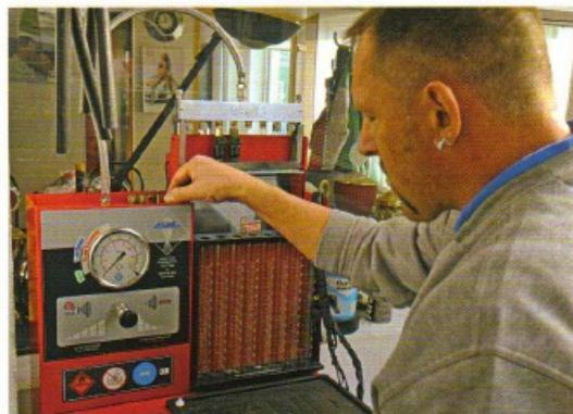
**Qualitätskontrolle:** Mit dem ASNU-Prüfstand wird die Leistung von Einspritzventilen gemessen
